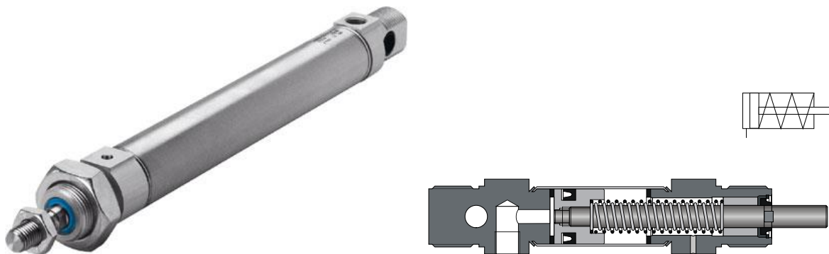
Abbildung 5.4: Realbild, Schnittdarstellung und Schaltsymbol eines einfachwirkenden Zylinders
